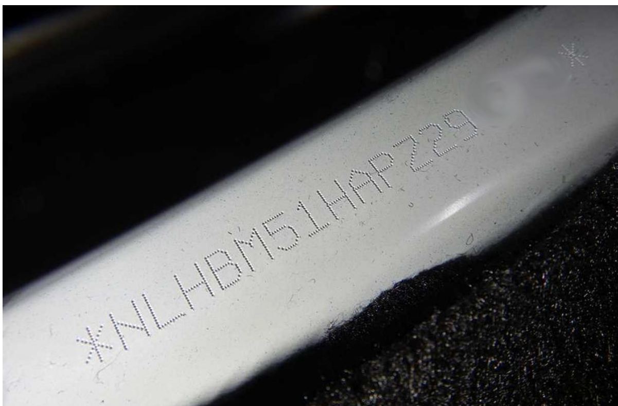
Ukážka VIN čísla vygravírovaného na karosérii vozidla. Zdroj: ko.sk
